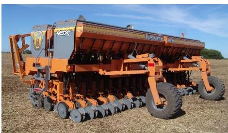
**MSX.** Es una máquina multifunción que sirve para aplicar fertilizantes y semillas en la siembra de múltiples cultivos. Y todas las combinaciones posibles con tolvas simples o dobles. Sus cuerpos de siembra angostos, sin mantenimiento y autolubricados permiten, con 3 modelos, 8
