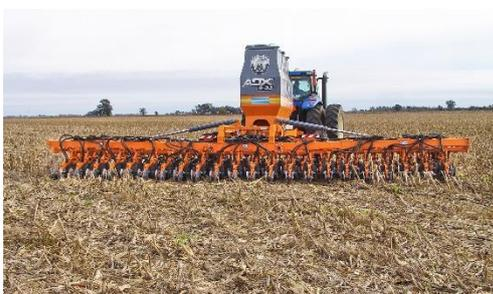
**ADX Air Drill.** Es una máquina multigrano ya que permite sembrar grano fino y grueso. Los granos finos con sistema neumático y los gruesos con sistema mecánico de placas. Permite una copia fiel del terreno con cualquier tipo de rastrojo. Tiene un sistema de plegado de
