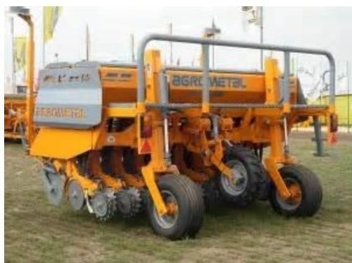
**Mini Mega.** Es una sembradora producida especialmente para pequeños establecimientos por su tamaño y costo. Con un ancho máximo de labor y transporte de 3,60 metros hasta un mínimo de 2,45 metros, cuenta con lanza de trabajo de 3 puntos o convencional asistida hidráulicamente.
