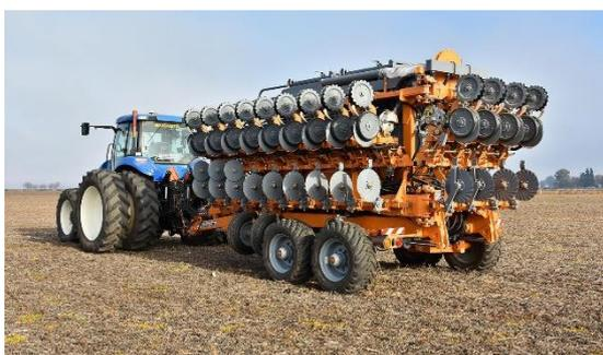
**APX air planter.** Es una máquina fácil de transportar y precisa para sembrar. Es un equipo para la siembra de granos gruesos. Tiene un tamaño de 11 metros de ancho de labor (22 líneas a 52,5 cm), con tolva montada sobre trailer con balancín y alerones flexibles. Sus alerones se pliegan
