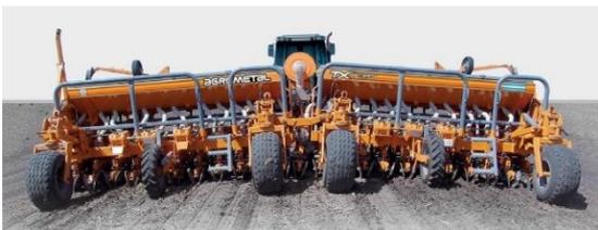
**TX Mega.** Es una maquina versátil y precisa. Cuenta con monotolva para simple y doble fertilización y monotolva de semilla para dosificador neumático y a placa horizontal. Sus 7 posibles configuraciones
