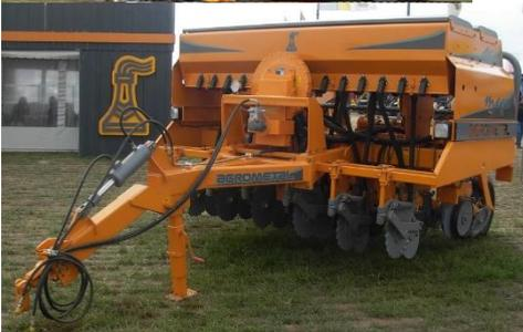
**MXW.** Es una sembradora producida para terrenos de forma irregular o con superficies reducidas. Pensada para pequeños productores es fácil de portar y de trasladar, la sembradora se adapta a todos los suelos con muy poco requerimiento de potencia.
