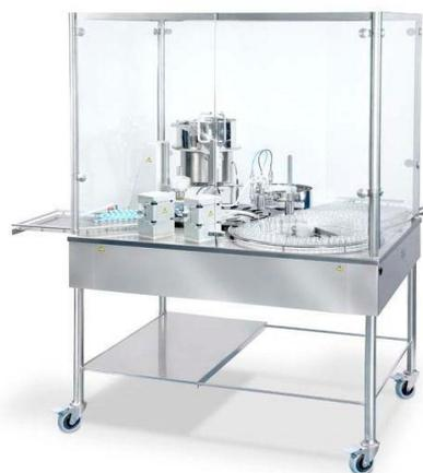
La máquina es una combinación de llenadora – cerradora compacta para frascos de plástico de productos líquidos. Tiene una capacidad de producción de entre 3600 a 6000 unidades/hora. Su diseño ha sido realizado conforme a las normas cGMP y de la US FDA en especial correspondencia con las exigencias de la industria farmacéutica, biotecnológica, cosmética, química e industrias afines.
