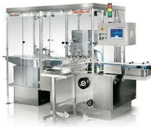
La máquina es una llenadora- cerradora volumétrica / de gravedad / intermitente para líquidos Se utiliza para dosificar volúmenes entre 0,25 ml a 500 ml con una velocidad de hasta 100 frascos por minuto lo que da un total de 6000 unidades/hora. La llenadora se utiliza para productos farmacéuticos (Jarabes)
