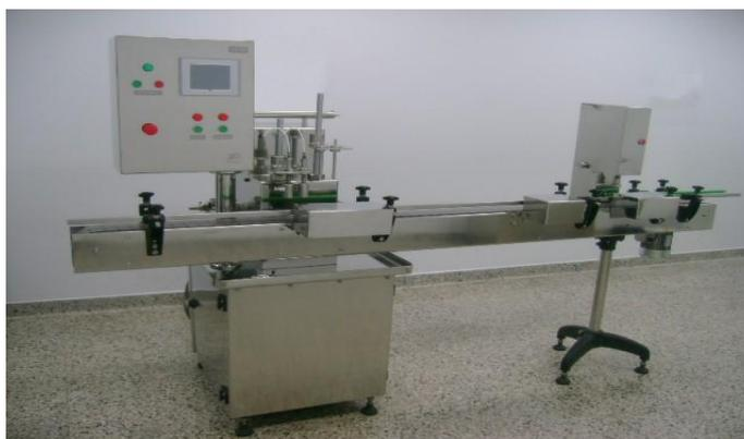
Ilustración 21: Llenadora LL-10 con capacidad máxima de producción 2200Un/Hr.
