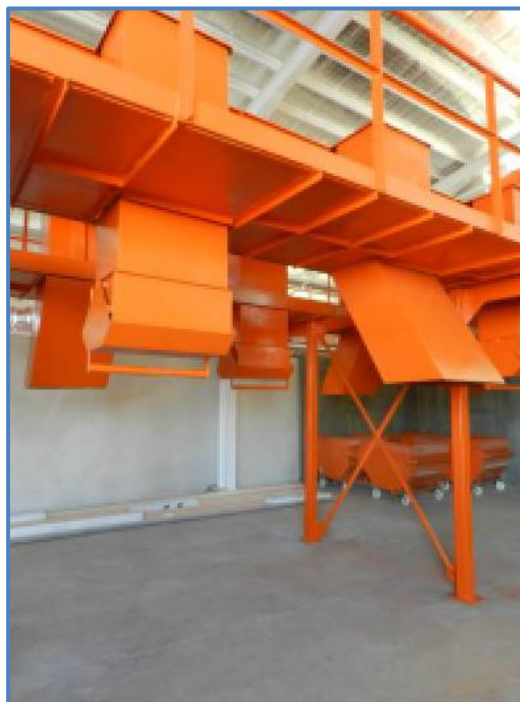
ILUSTRACIÓN 29 – VISTA INFERIOR DE LA CINTA DE CLASIFICACIÓN. (FUENTE: MEMORIA DESCRIPTIVA PROYECTO GIRSU VIRCH-VALDES)
