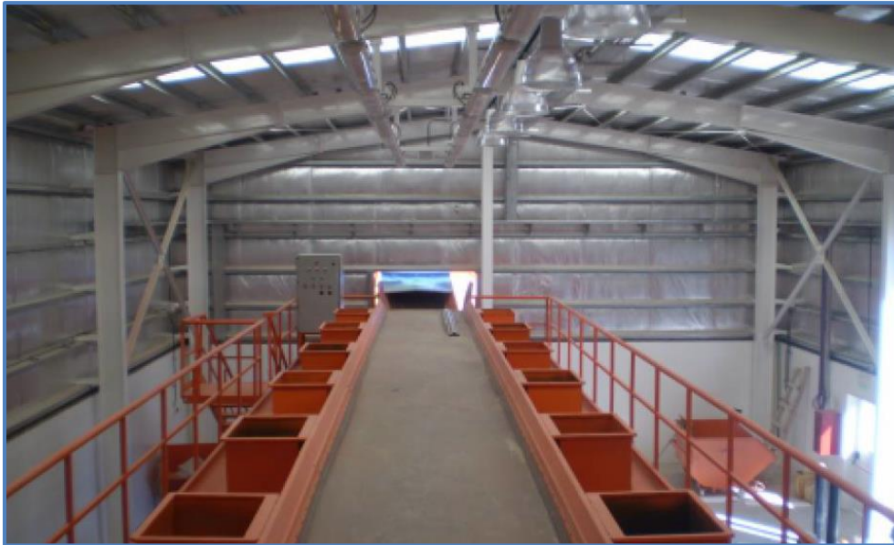
ILUSTRACIÓN 28 – CINTA DE CLASIFICACIÓN DE LA PSyT. (FUENTE: MEMORIA DESCRIPTIVA PROYECTO GIRSU VIRCH-VALDES)
