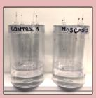
El sistema se compone de dos recipientes dispuestos uno dentro del otro. El envase interno cuenta con orificios muy pequeños tanto en la parte superior, para el ingreso de oxígeno, como en la parte inferior, para la entrada del vapor proveniente del agua contenida en el frasco de mayor tamaño. La tapa del receptáculo más chico cuenta cuatro agujeros de mayor tamaño para la inserción de los tips con sus respectivos capilares. Cada capilar contiene una solución líquida con:
