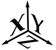
Partimos de un punto en una posición determinada. La repetición de ese punto en dirección X genera una línea. La misma operación aplicada sobre la línea en dirección Y origina un plano. Si reiteramos la secuencia sobre el plano y en dirección Z, obtendremos un *cuerpo* geométrico o *volumen* (un prisma recto en este caso).
