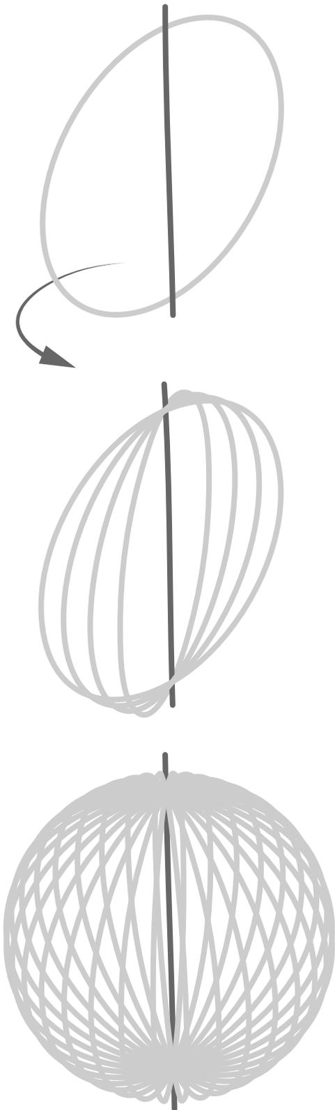
La superficie esférica es una superficie de revolución, que se genera a partir de la rotación de una circunferencia alrededor de un eje virtual que pasa por el centro de dicha curva. Ambos elementos deben estar en el mismo plano, o ser *coplanares*, para cumplir las condiciones de generación de una esfera.
