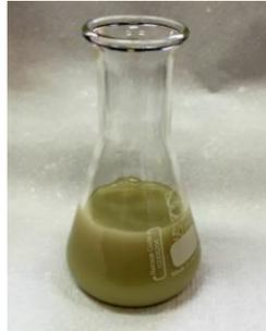
Figura 4: Nanopartículas de Ag estabilizadas con citrato.
