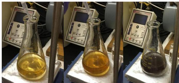
Figura 28: Evolución de la síntesis de nanopartículas de Cobre reducidas con borohidruro.
