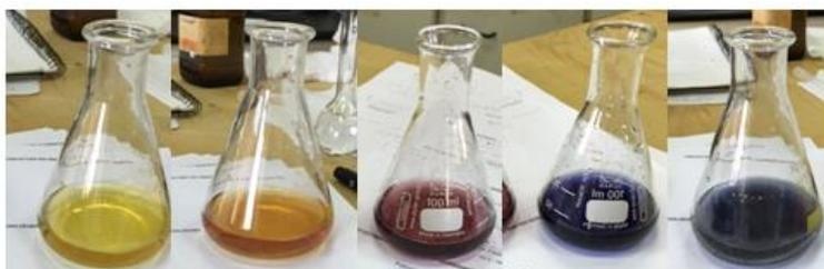
Figura 7: Evolución de la coloración en función del tiempo, durante la síntesis de Nanoprismas de Ag.
