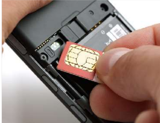
Figura 3 - Ejemplo de Mobile Equipment con SIM
