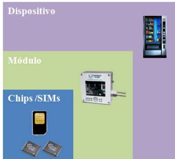
Figura 17 - Componentes de un dispositivo M2M
