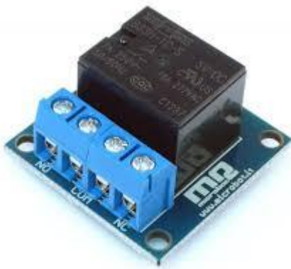
Figura 5: Relay de dos entradas.
