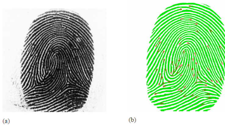
Figura 1.b. Mapa de bits de la huella digital obtenida del lector (a), después de procesar (b) se destacan las minucias encontradas en rojo
