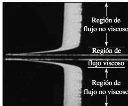
Figura 1: Flujo de fluido de una corriente originalmente uniforme sobre una placa plana y las regiones de flujo viscoso (próximas a la placa en ambos lados), así como no viscoso (lejos de la placa).
