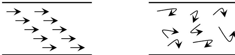
Figura 2: Flujo laminar vs Flujo turbulento
