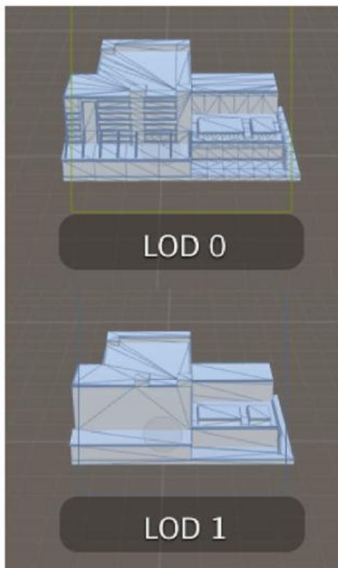
Figura 13: Utilizando el concepto de LOD para disminuir los polígonos. Imagen propiedad de Unity.
