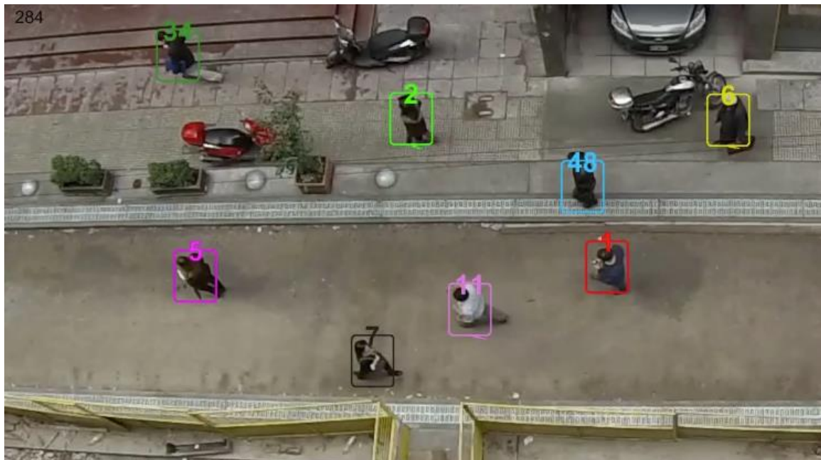
Figura 66: salida en pantalla para un “frame” dado del método “Continuous Energy Minimization for Multi-Target Tracking”.
