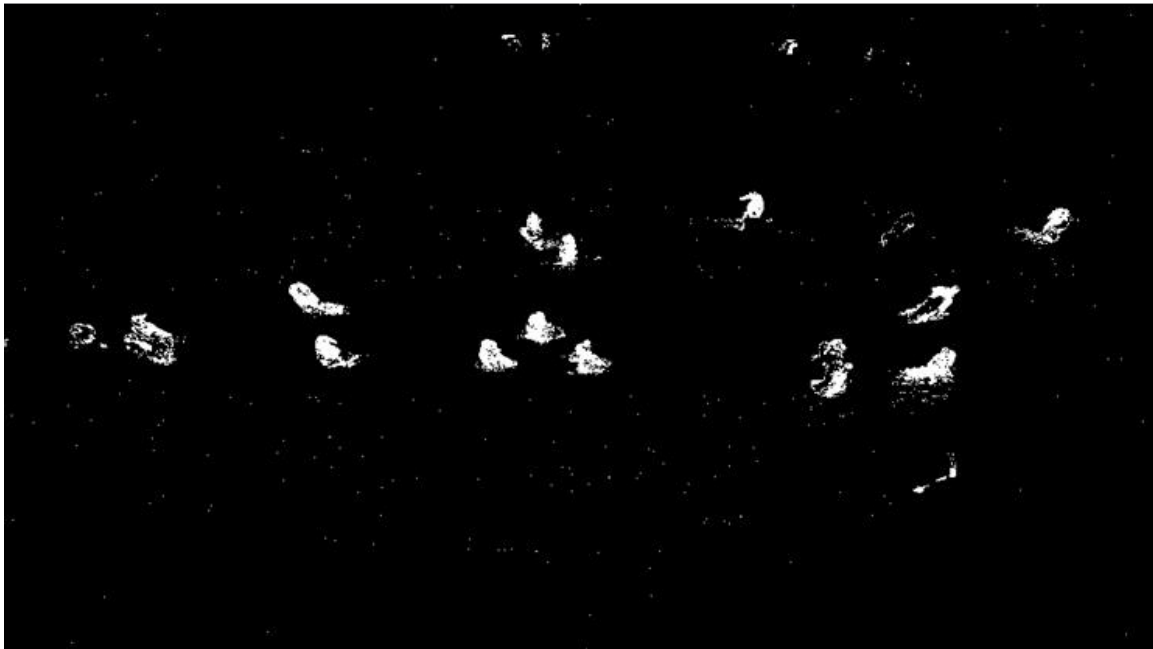
Figura 50: resultado de aplicar el método de sustracción de fondo a un “frame”.
