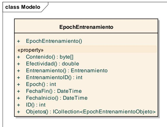
La clase “EpochEntrenamiento” representa una iteración de una configuración de entrenamiento de una red neuronal. En la propiedad “Contenido” se almacena la red neuronal (con su configuración de pesos y bias) luego de la iteración de entrenamiento. En la propiedad “Efectividad” se guarda el porcentaje de efectividad con el cual está reconociendo los objetos. En la propiedad “Objetos” se guarda la efectividad con la que está reconociendo cada objeto.
