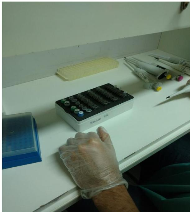
**Figura 11:** Armado de la Master Mix bajo campana. Es necesario limitar la cantidad de luz presente en la campana ya que el Sybr Green es un fluoróforo fotosensible.
