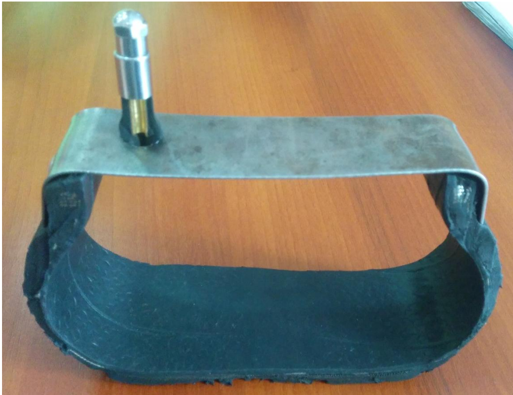
Ilustración 9: Corte transversal de neumático y válvula
