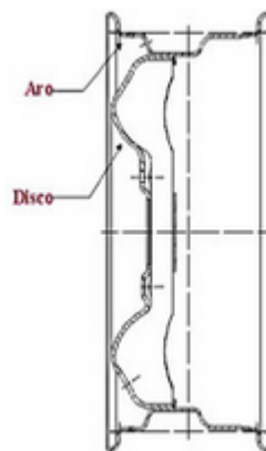
Ilustración 3: Corte Transversal de una Llanta
