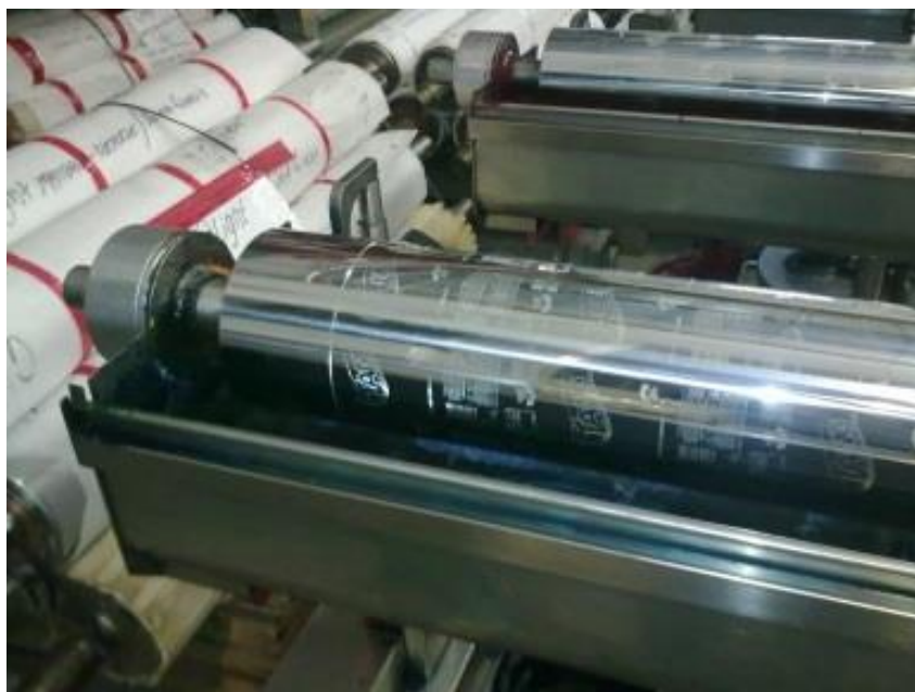
Ilustración 1.11: Cilindro de rotograbado.
