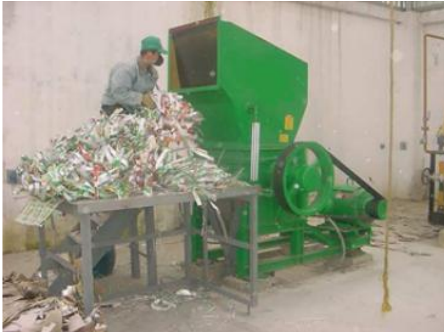
Figura 15 : Trituración del material Tetra Pack reciclado
