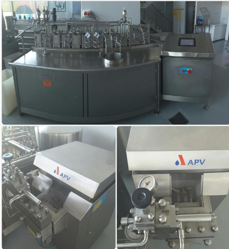
*Foto 7. Equipo pasteurizador y homogeneizador continuo de dos etapas.*
