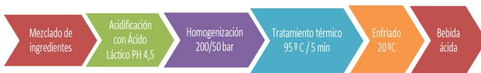
*Diagrama 8. Proceso de elaboración de la bebida ácida.*
