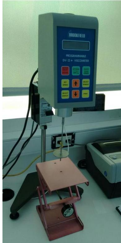
*Foto 4. Viscosímetro utilizado para el desarrollo de la bebida ácida.*
