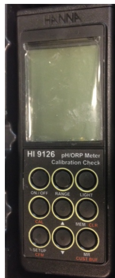
Figura 16: Imagen de equipo utilizado para determinar el pH del producto de interés
