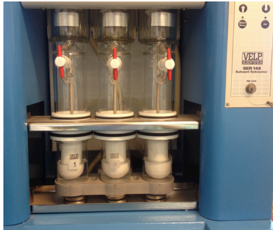
Figura 20: Equipo Soxhlet “Velp Scientifica” utilizado para extracción de grasas
