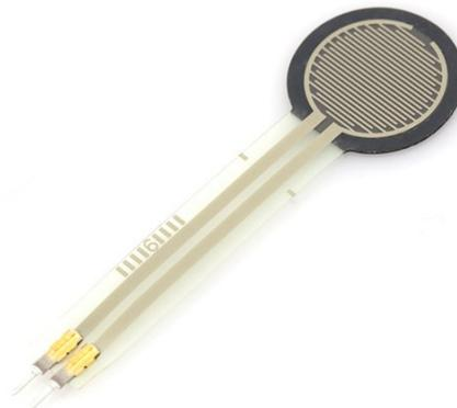
Figura 2.5.4 Transductor resistivo.
