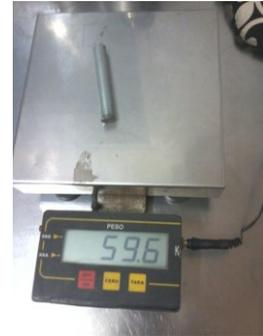
Figura 7.7 Peso del tornillo del contrapeso
