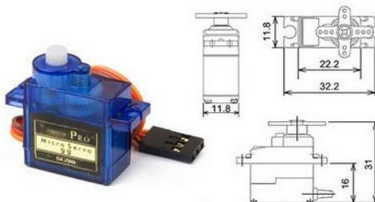
Figura 2.3.6 Figura del micro servo Sg90.
