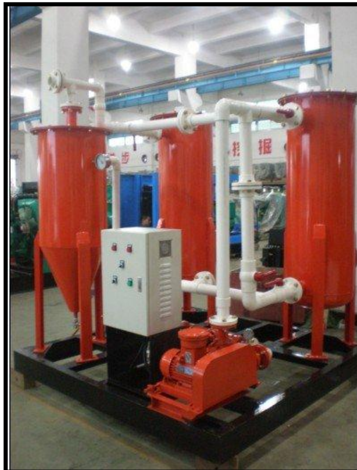
Figura 29: sistema de acondicionamiento del biogás
