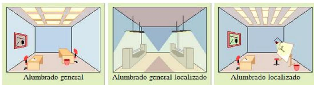
Figura 8: Tipos de alumbrado, fuente: Luminotecnia, Iluminación para interiores
