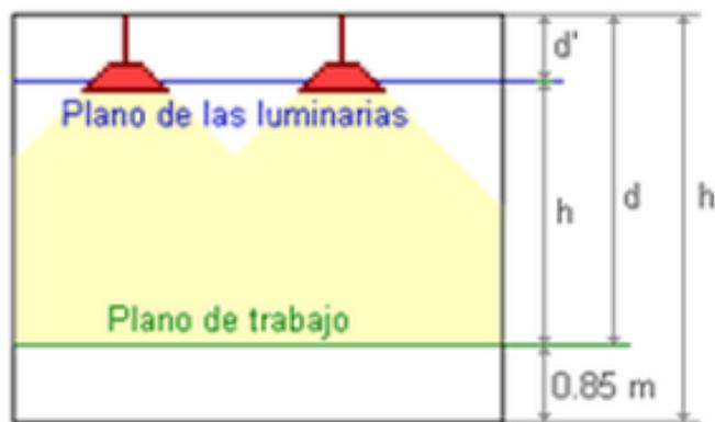
Figura 12: Altura de suspensión de las luminarias, fuente: Luminotecnia, Iluminación para interiores
