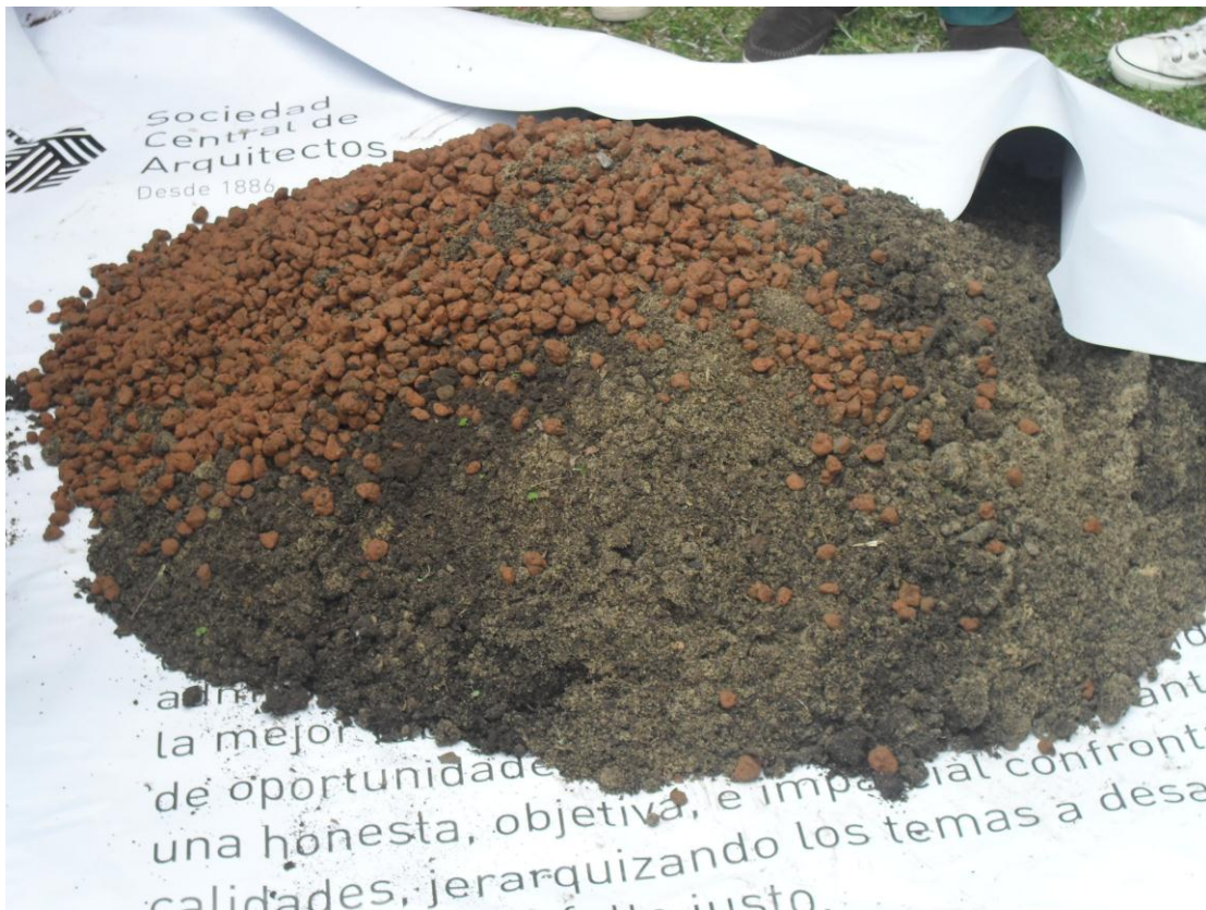
Figura 21: agregado de leca a la mezcla
