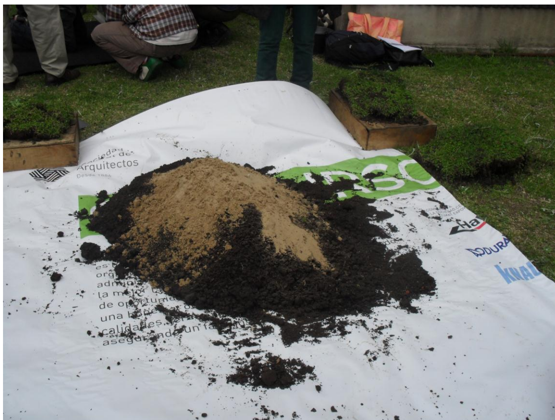
Figura 19: mezcla 1 balde de arena por 3 de tierra
