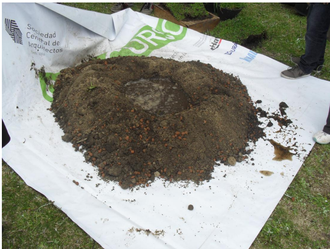
Figura 22: agregado de agua a la mezcla
