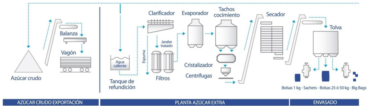
Fig. 1.9: Proceso Refinería + embolsado. Fuente: Ledesma SAAI
