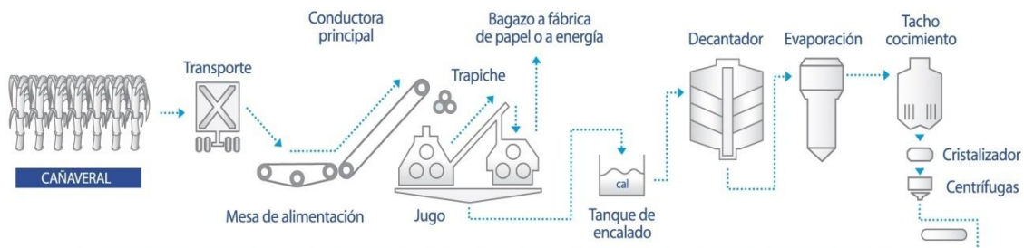
Figura 1.6: Proceso fábrica de azúcar. Fuente Ledesma SAAI
