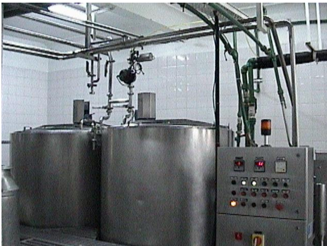
Figura 5. Miniplanta. Conjunto integrado por: Pasteurizado, homogenizado e intercambiador de placas.
