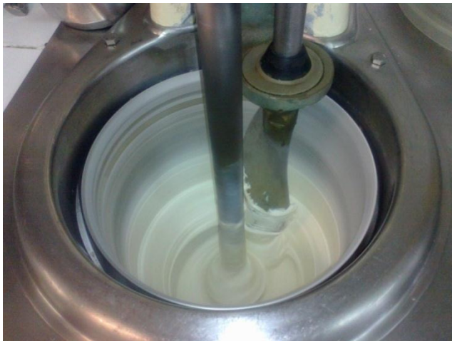
Figura 3 y 4. Muestran un freezer vertical. Incorporación de aire del ambiente por batido.
