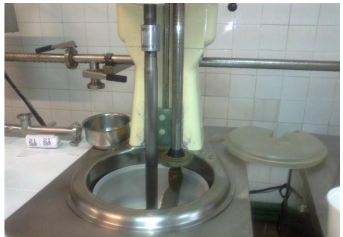
Figura 3 y 4. Muestran un freezer vertical. Incorporación de aire del ambiente por batido.
