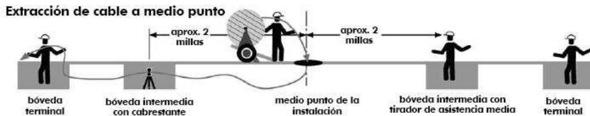
Figura 8: Extracción de cable a medio punto.
