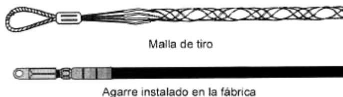
Figura 25: Malla de Tiro y Agarre Preinstalado.
