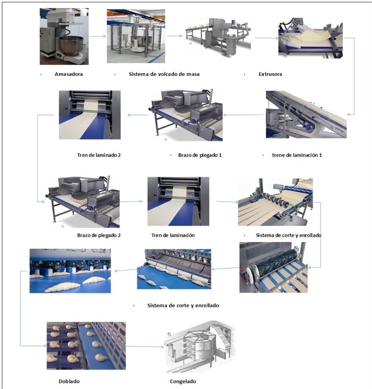
Figura 9: diseño de la planta productiva de medialunas automáticas
