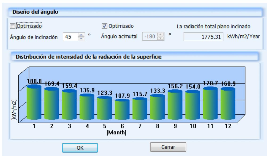
Figura 23: simulación intensidad de la radiación solar incidente en superficie a 45°
