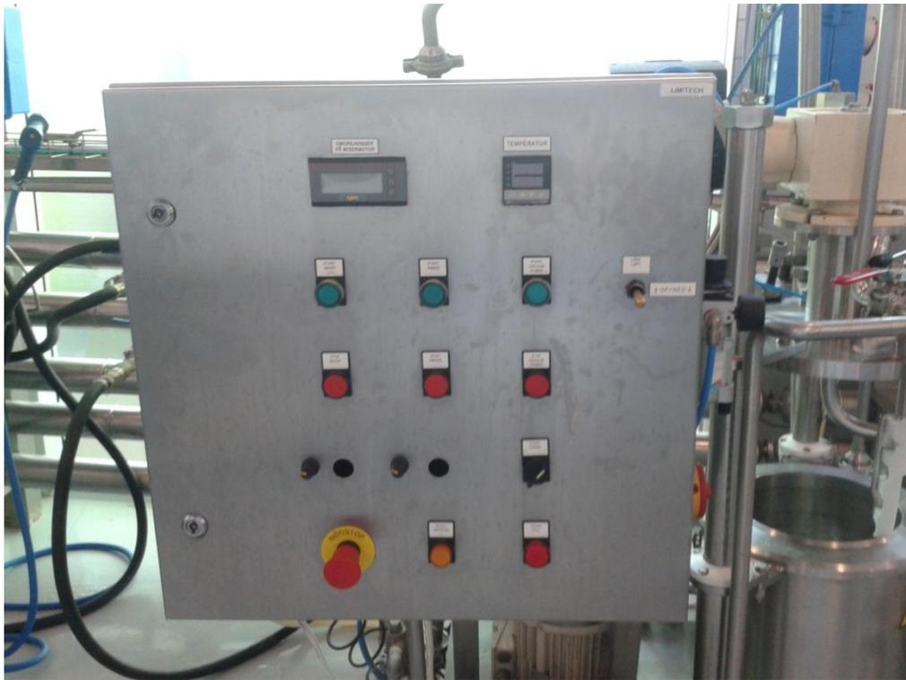
Figura 37: Panel de control del cocinador Limitech. Las funciones del tablero principal son velocidad de agitación, apertura de válvulas en camisa para tratamiento térmico y arranque de bomba de vacío.
