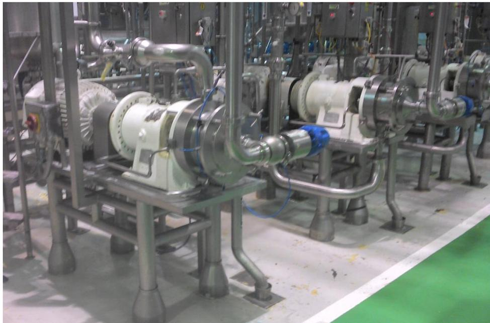
Figura 28: Molinos coloidales para el emulsionado de aderezos. Unilever planta Pilar.
