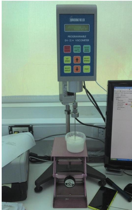
Figura 40: Viscosímetro Brookfield DV-II, con el que se realizaron las mediciones de viscosidad.
