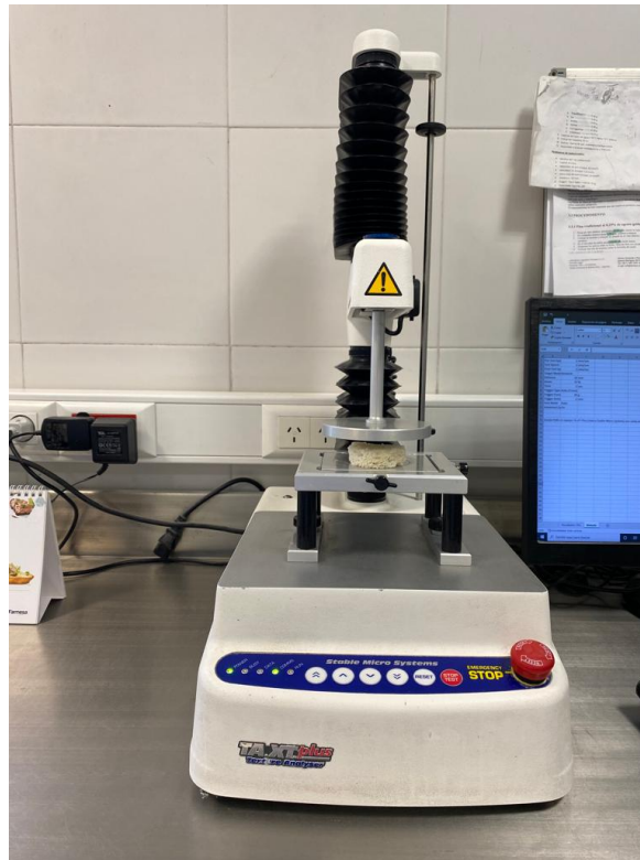
Figura 5: Texturómetro TA.XT Plus perteneciente a la empresa “Farnesa”
