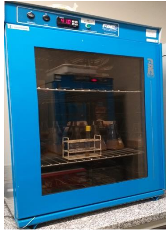
Figura 34 – Estufa de incubación marca FAC seteada a 41°C.
