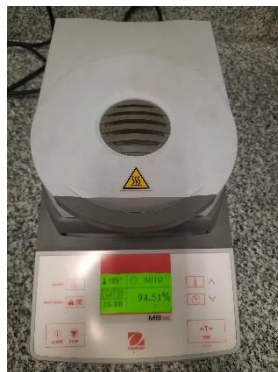
Figura 54 – Balanza analizadora de humedad OHAUS MB35.
