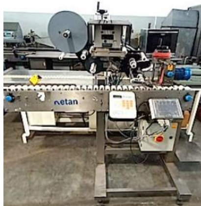
Figura 74: Etiquetadora automática para autoadhesivas
