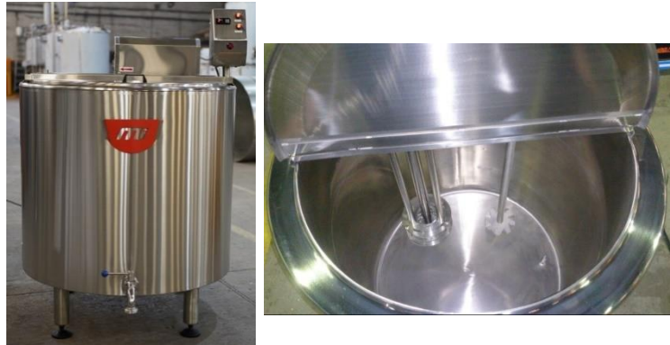
Figura 71: Tanque encamisado con agitador
