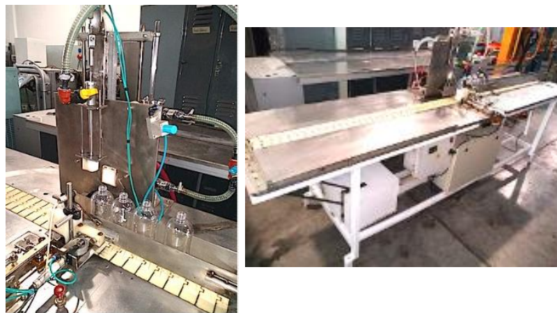
Figura 73: Llenadora automática para líquidos y viscosos
