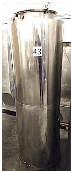
Figura 72: Tanque de acero inoxidable 450 litros
