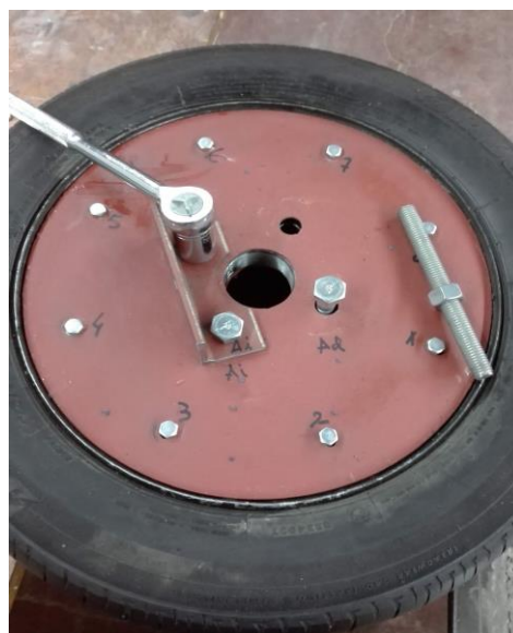
Figura 38: Ajuste y acople con perfil L.
