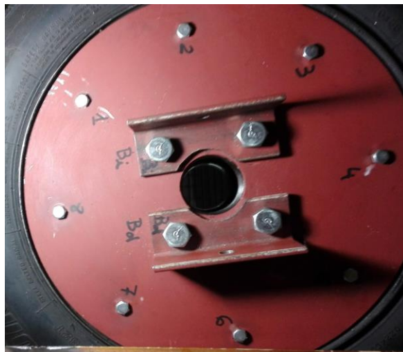
Figura 30: Chapa circular para la parte externa del neumático
