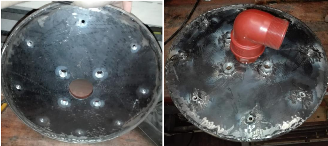
Figura 29: Chapa circular para la parte interna del neumático
