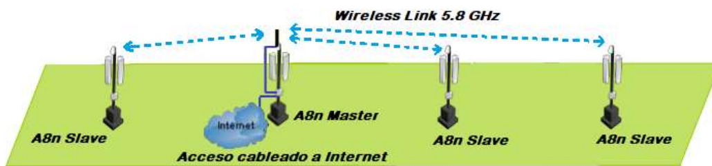
Figura N° 31 Esquema de conexión por wireless link
