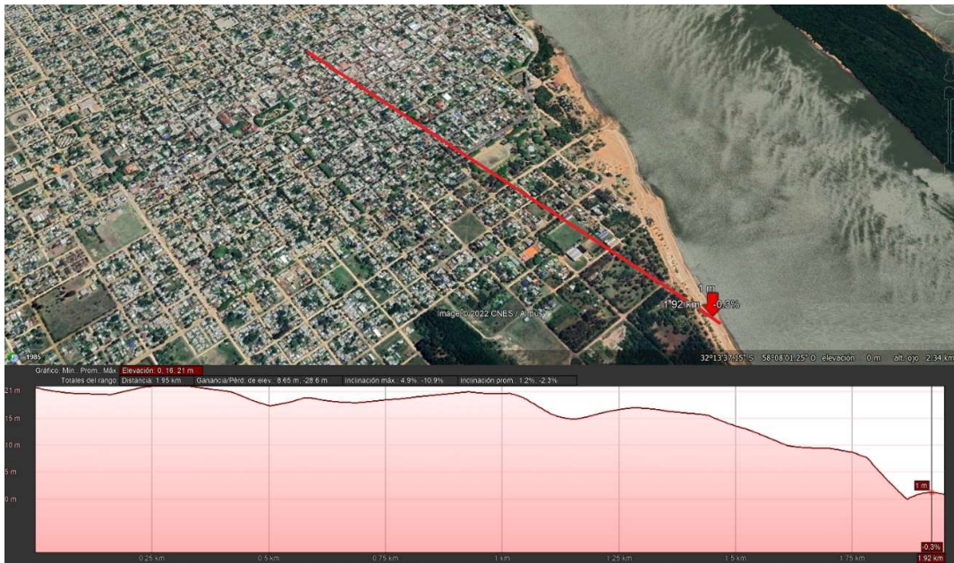
Figura N°3 Perfil del terreno desde la antena de Personal hasta la playa sur
