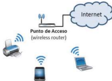
Figura N° 6 Topología de infraestructura
