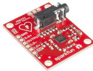
*Figura 21: ECG Sensor AD8232*
