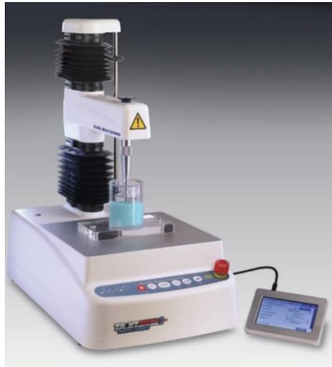
**Figura 8.** Texturómetro utilizado
