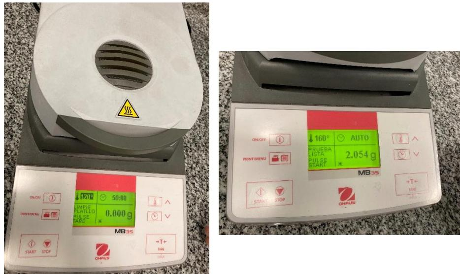
**Figura 24.** Fotos de la termobalanza utilizada
