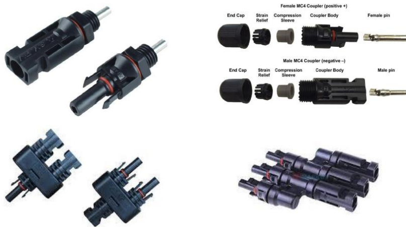
Figura 34: Superior: Izquierda, conectores MC4 macho y hembra armados para su uso. Derecha: despiece de conectores MC4 hembra (superior) y macho (inferior). Inferior: Accesorios para conectar serie o paralelo de varias filas o strings, También conocidos como splitters. Fuente: Subsecretaría de Energías Renovables y Eficiencia Energética – Presidencia de la Nación.
