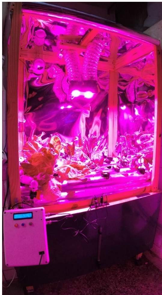
Figura 72: Huerta construida con cultivos y el sistema de iluminación activado
