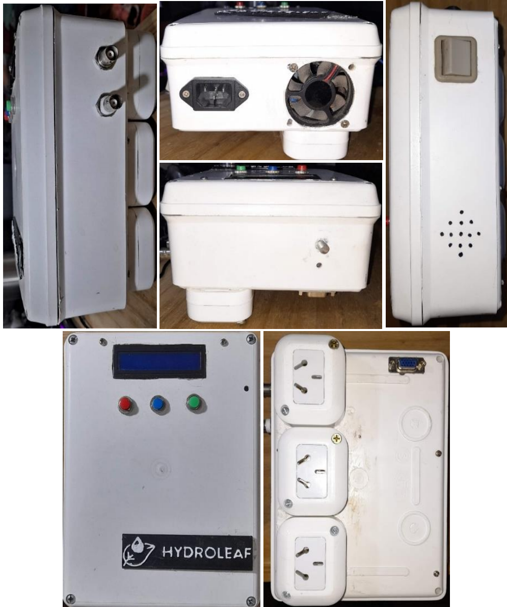
Figura 70: Caja con la electrónica terminada
