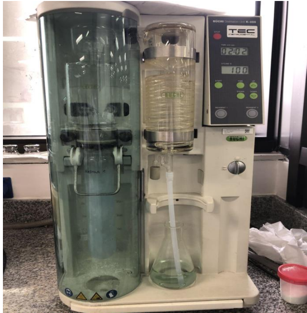
Figura 63. Equipo utilizado para determinación de proteínas. (Fuente: elaboración propia)
