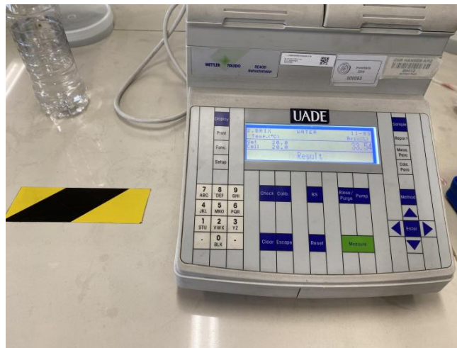
Figura 43. Refractómetro METTLER TOLEDO RE40D. (Fuente: elaboración propia)
