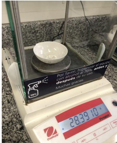
Figura 54. Pesaje de cenizas blancas en balanza analítica. (Fuente: elaboración propia)
