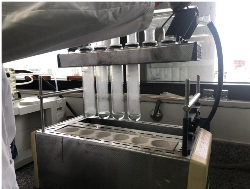
Figura 61. Instrumentos utilizados para determinación de proteínas. Büchi Digestion Unit K-424. (Fuente: elaboración propia)
