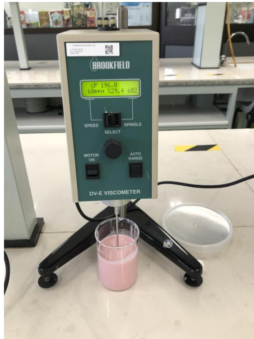
Figura 41. Viscosímetro de Brookfield modelo DV-E. (Fuente: elaboración propia)
