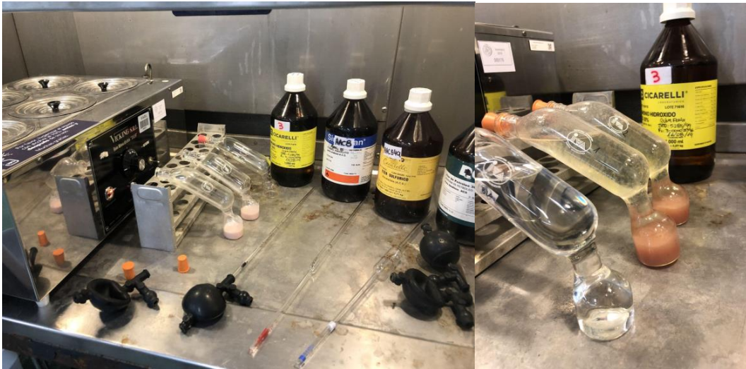
Figura 56. Instrumentos utilizados para determinación de grasas. Método Rosse Gottlieb. (Fuente: elaboración propia)
