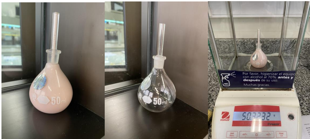
Figura 42. Picnómetro con helado, picnómetro sin helado, pesado de picnómetro con helado en balanza analítica. (Fuente: elaboración propia)
