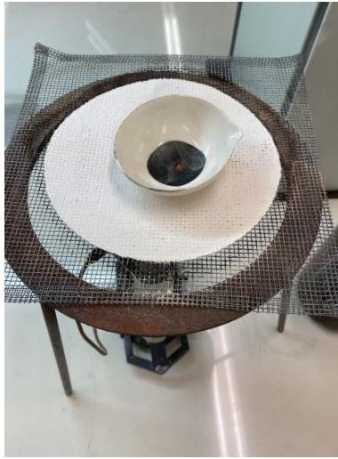
Figura 52. Calcinación de la muestra en mechero. (Fuente: elaboración propia)
