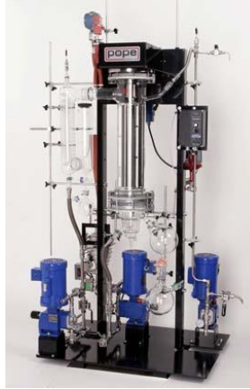
Figura 12: Torre de destilación Pope Cannabis
