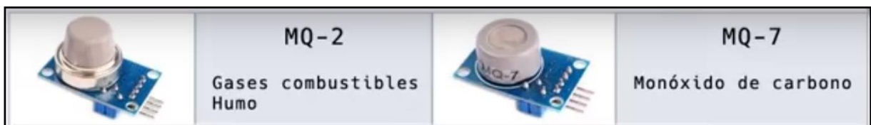
Figura 3.1.2.2.3: Sensores MQ-2 y MQ-7 y sus gases de mayor sensibilidad.
