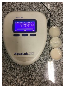
Figura 32: Equipo para medir actividad de agua. Fuente: Propia.
