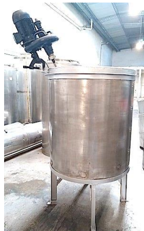
Figura 38: Tanque de acero inoxidable con camisa. Fuente: Santolíquido Equipos Industriales.
