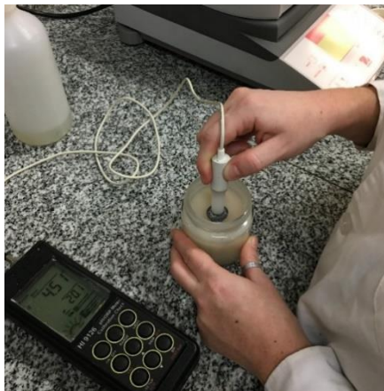
Figura 34: Medición del pH utilizando un pHmetro. Fuente: Propia.
