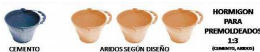
Figura 14: Proporción general para premoldeados de hormigón.
