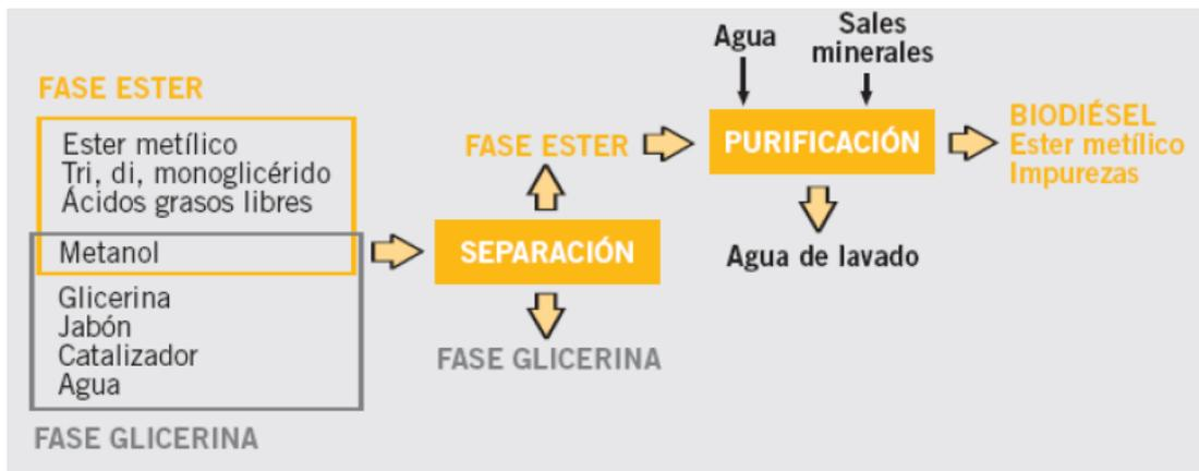
Figura 13: Esquema de los procesos de separación y purificación del Bio-Diesel
