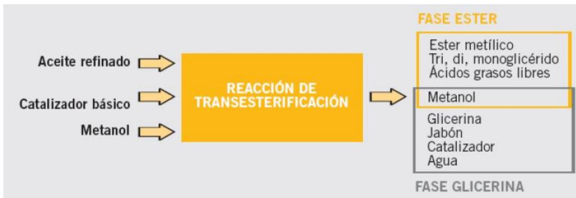
Figura 12: Esquema del proceso de transesterificación
