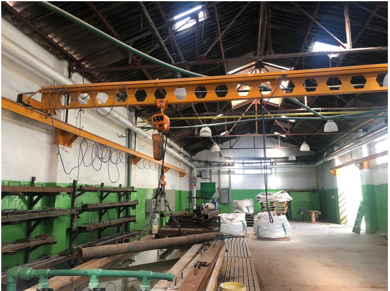
Figura 31: Maquinaria con grúa para mover los moldes.
