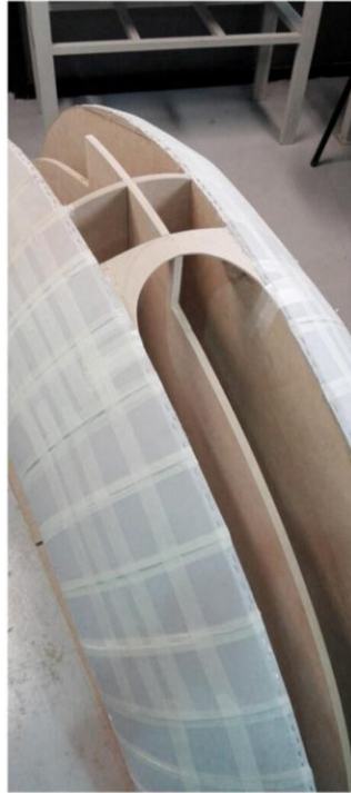
Secuencia que demuestra cómo se materializó la superficie de doble curvatura del frente de la nave con el método A (estructura de cartón+cartapesta+masilla+lija)
