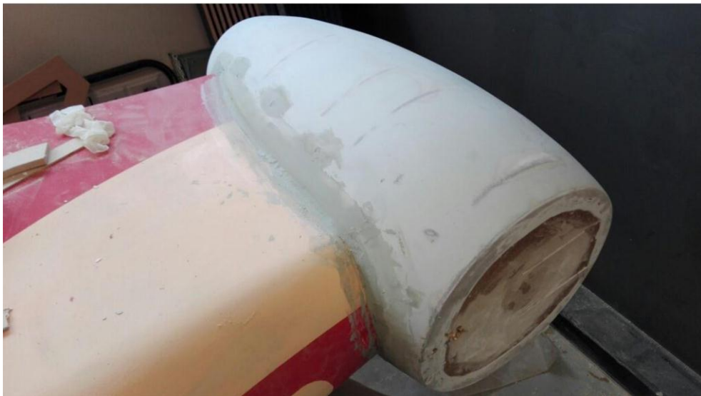
Secuencia que demuestra cómo se materializó la superficie de doble curvatura de una de las turbinas con el método C (estructura de waffle+telgopor+tela+resina+masilla+lija)
