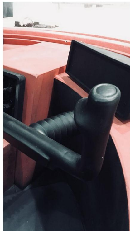
Impresión 3d del volante. El mismo, al tratarse de una superficie compleja pero pequeña, fue realizada con el método E (impresión 3d+masilla+lija)
