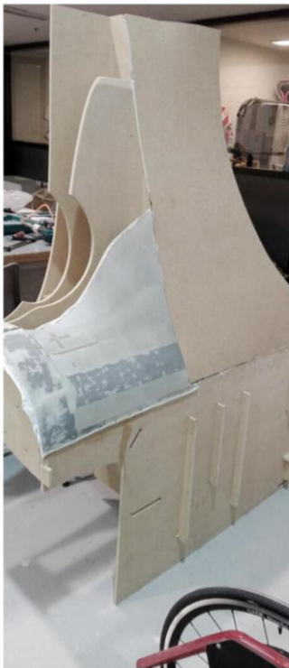
Secuencia que demuestra cómo se materializó la superficie de doble curvatura de una de las alas con el método B (estructura de waffle+tela+resina+masilla+lija)
