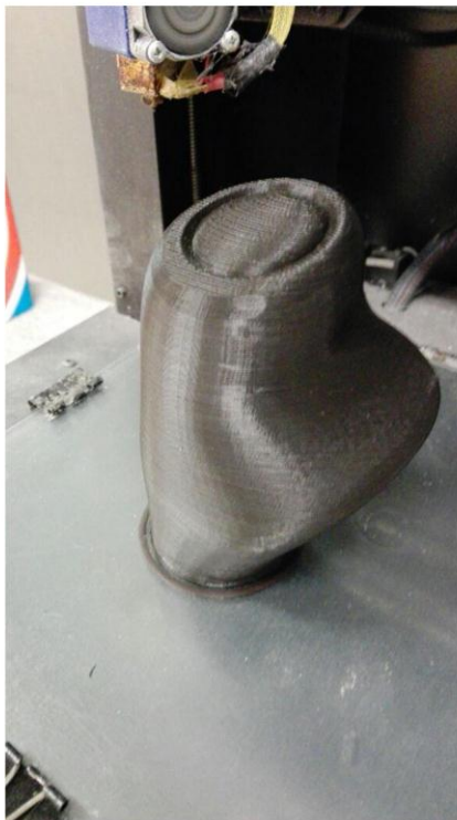
Impresión 3d del volante. El mismo, al tratarse de una superficie compleja pero pequeña, fue realizada con el método E (impresión 3d+masilla+lija)
