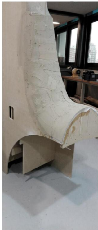
Secuencia que demuestra cómo se materializó la superficie de doble curvatura de una de las alas con el método B (estructura de waffle+tela+resina+masilla+lija)
