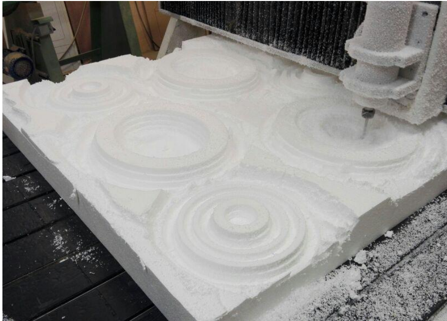
Ruteado 3D de las piezas de remate de la turbina. Finalmente estas piezas de doble curvatura fueron terminadas utilizando el método D (telgopor+enduido+lija) debido a que son piezas que no serían sometidas a esfuerzos grandes
