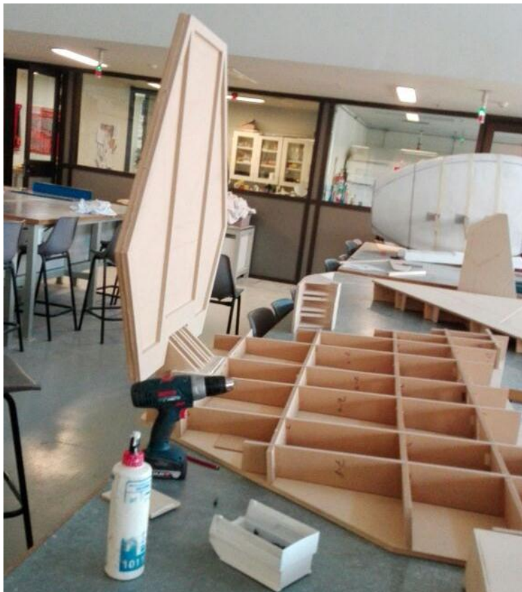
Armado de Ala
