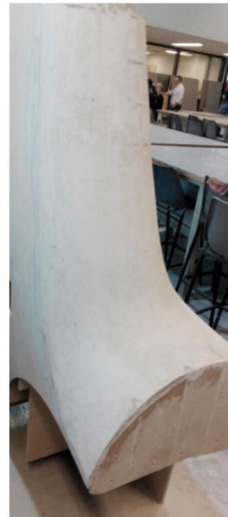
Secuencia que demuestra cómo se materializó la superficie de doble curvatura de una de las alas con el método B (estructura de waffle+tela+resina+masilla+lija)
