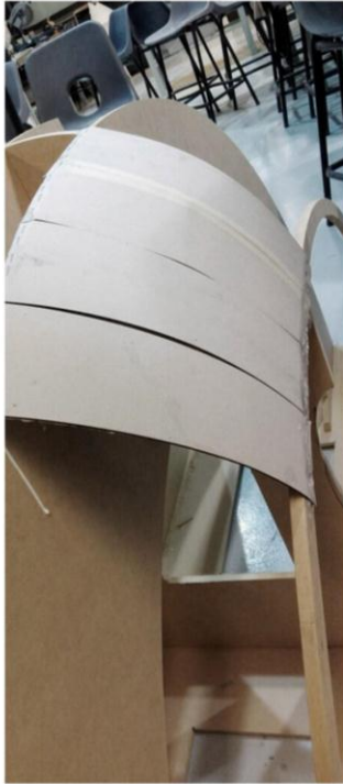
Secuencia que demuestra cómo se materializó la superficie de doble curvatura del frente de la nave con el método A (estructura de cartón+cartapesta+masilla+lija)
