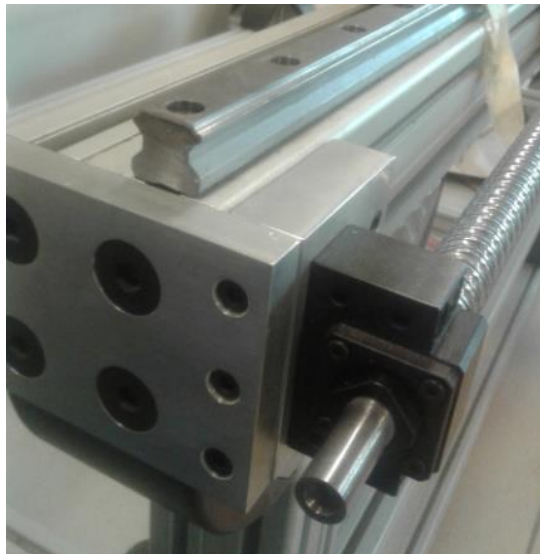
Fig. 22: Piezas de vinculación fabricadas
