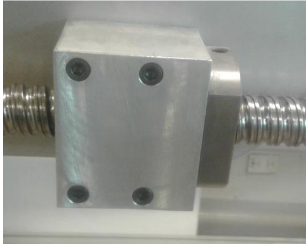
Fig. 21: Piezas de vinculación fabricadas
