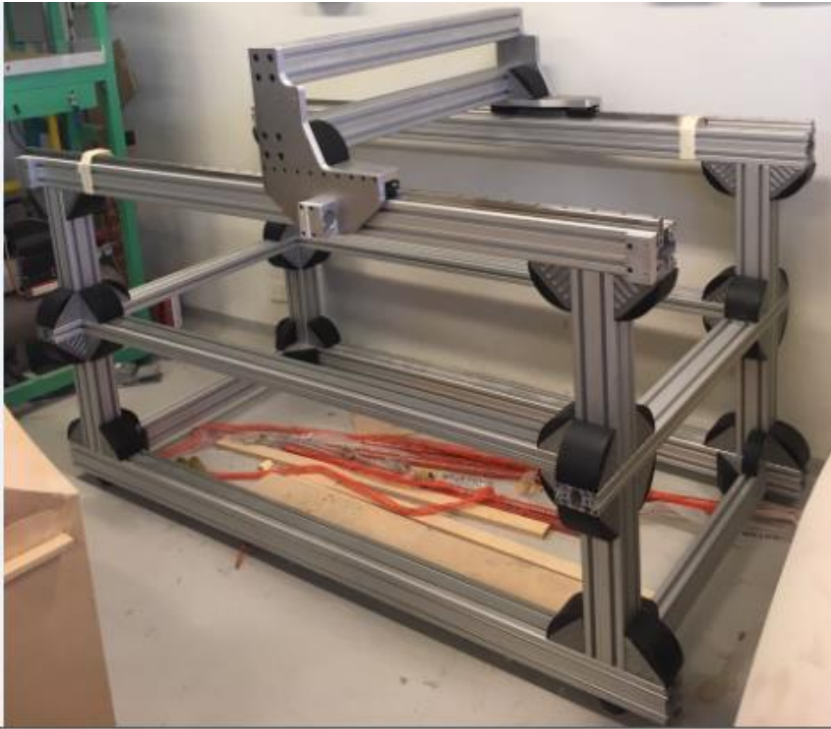
Fig. 8: Estructura escuadrada y nivelada
