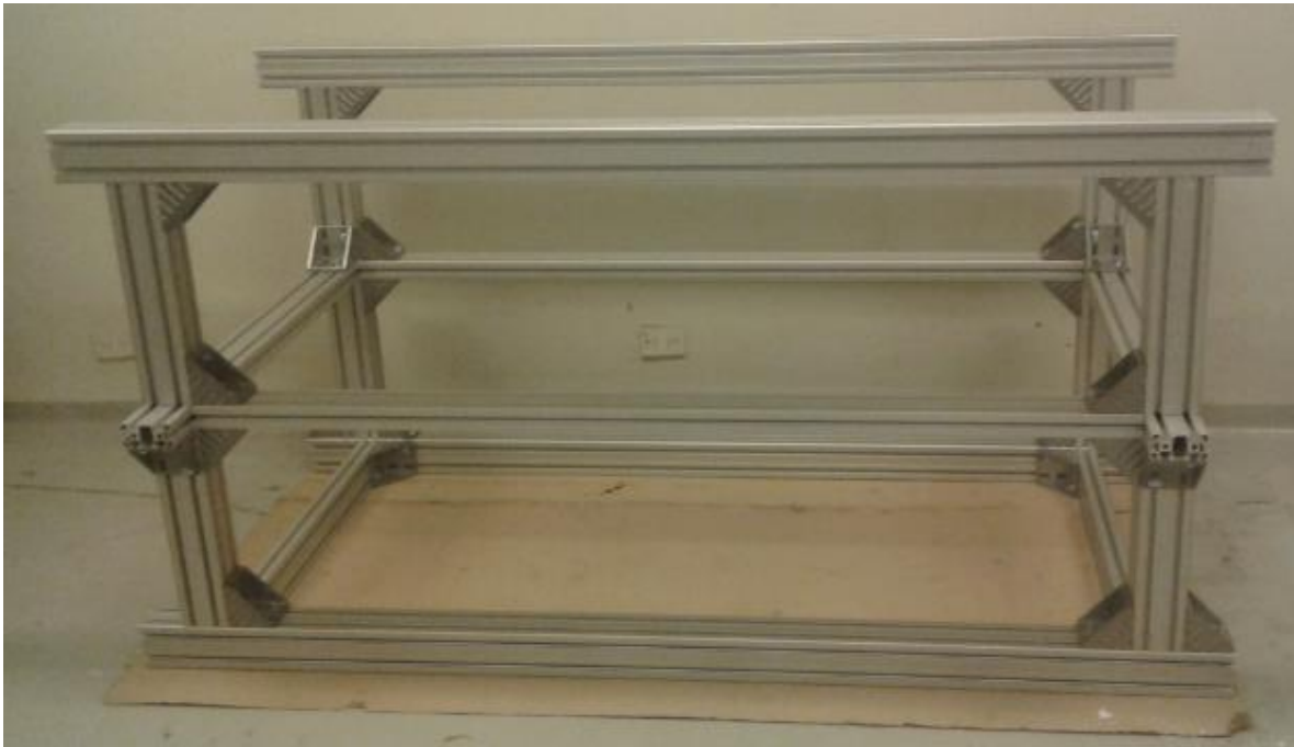
Fig. 4: Estructura base ensamblada
