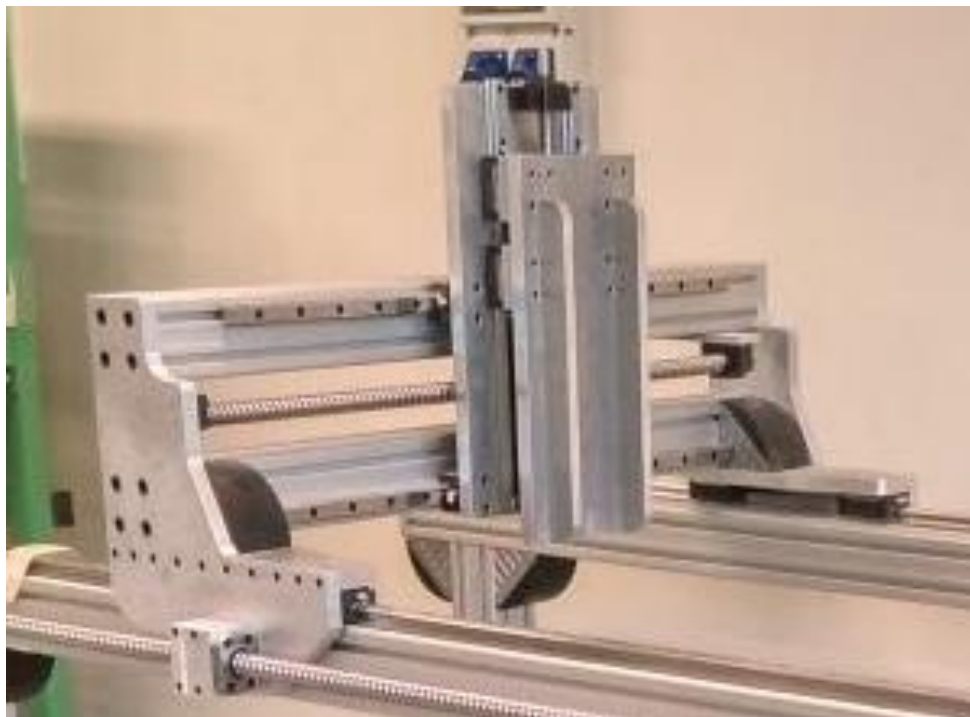
Fig. 6: Puente de la máquina
