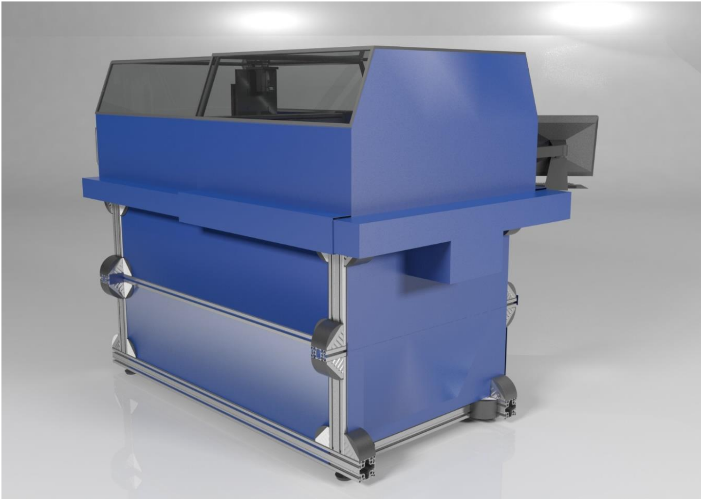
Fig. 36: Protecciones traseras de las partes mecánicas
