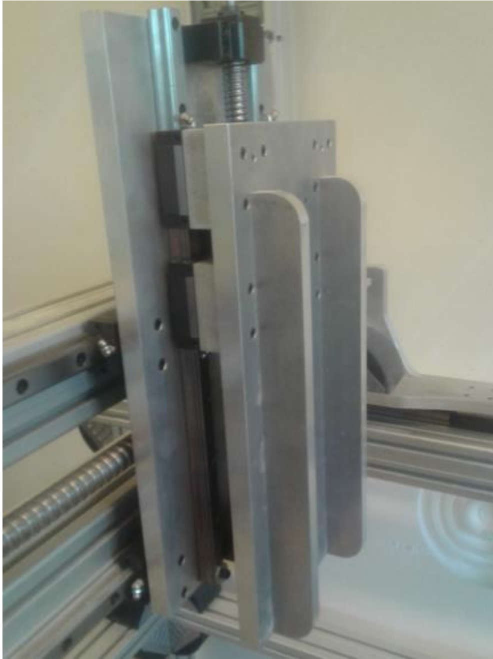
Fig. 15: Configuración del eje Z
