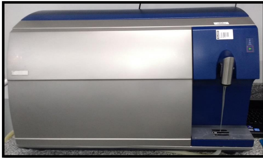
Figura 26. Equipo MilkoScan Foss. Utilizado para obtener porcentajes de proteínas y materia grasa de la leche.
