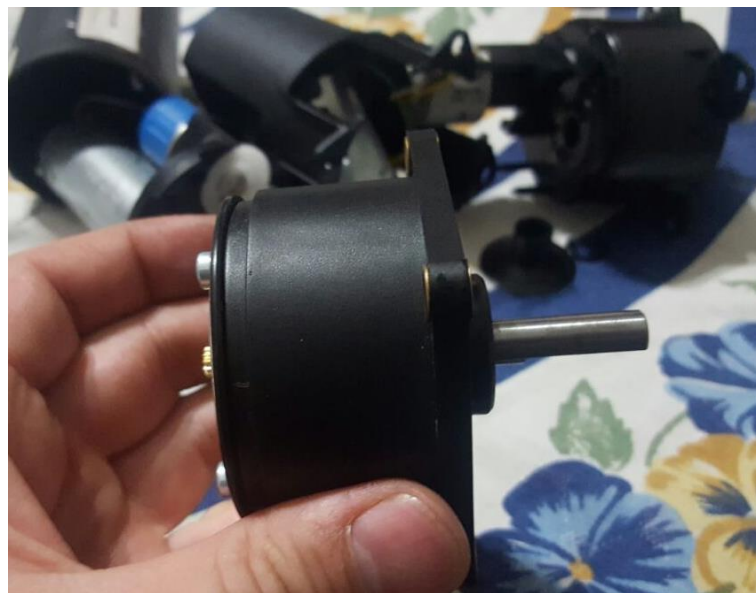
Fig.24 Reducción Motor Heilderberg
