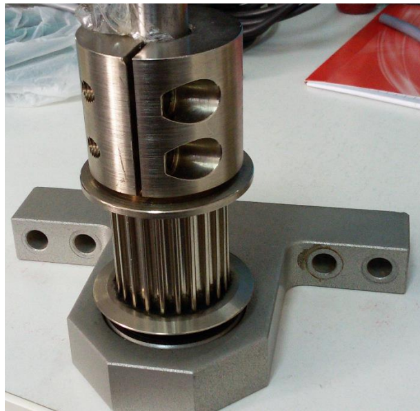
Fig.12 Base del brazo con rodamiento axial
