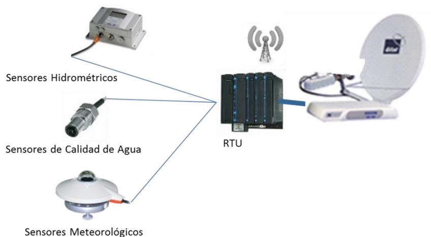
Figura 6: Esquema de una Estación Remota de Monitoreo
