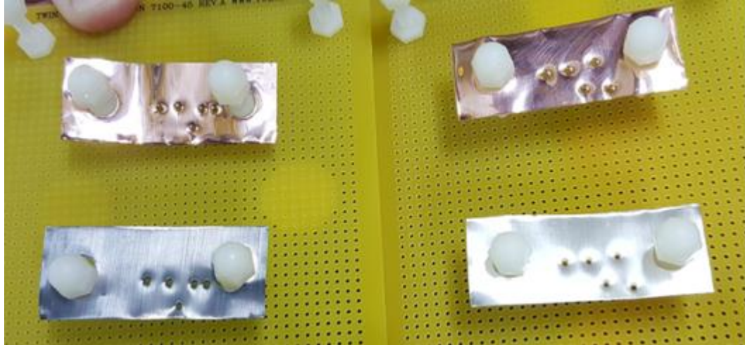
Figura 41: Cupones de cobre y plata en el interior del sitio A (Izq.) y cupones luego de medición del exterior del sitio (Der.) Inspección visual realizada por los alumnos.
